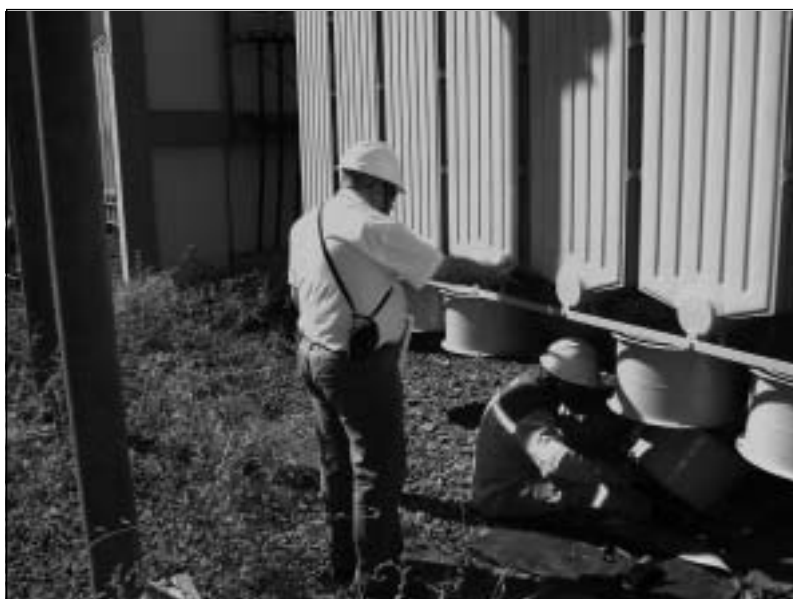
Figuras 3 e 4. Ilustração. Técnico fazendo medições objetivas em campo com dosímetro para ajustes dos pesos dos componentes elétrico e magnético.
